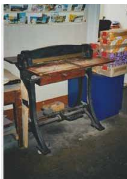
Perforationsfußhebelmaschine Maschinenfabrik Albert Schatz, Grimma, Baujahr unbekannt
